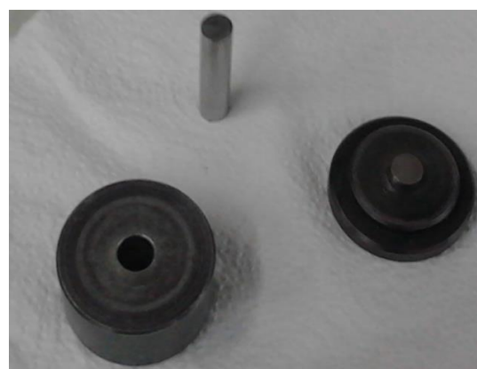
شکل (۲) قالب سخت کاری شده برای انجام فشرده گی استاتیکی
