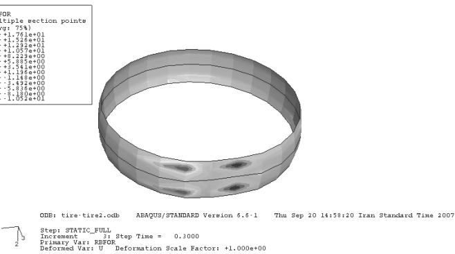
شکل (۷) مقدار بار در لایه دوم حامل REINFORCE
