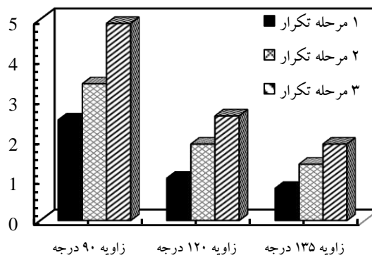
شکل (۱۲) نمودار مقایسه کرنش در زوایای مختلف با رویکرد تکرار مراحل
