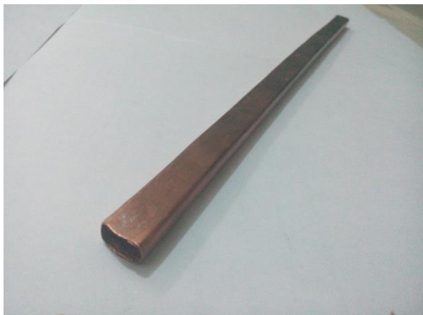
شکل (۹) قطعه شکل دهی شده بعد از غلتک سوم
