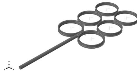
شکل (۲) مونتاژ غلتک‌ها و لوله در نرم افزار Abaqus
