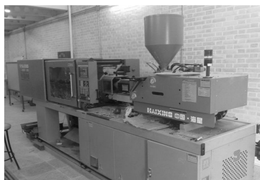
شکل (۱) دستگاه تزریق مدل HFX88 استفاده شده در آزمایش.
